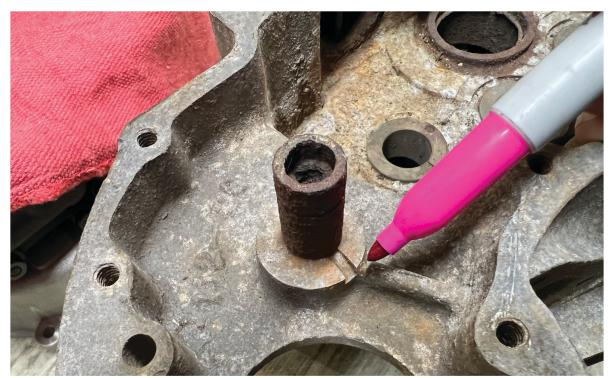
CREATING OIL RELIEF FOR IDLER GEAR MAY BE REQUIRED. PASSAGE SHOULD BE CREATED AS OEM PHOTO SHOWN ABOVE.
