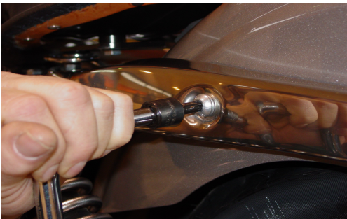
3. Remove the front fender strut bolt.
